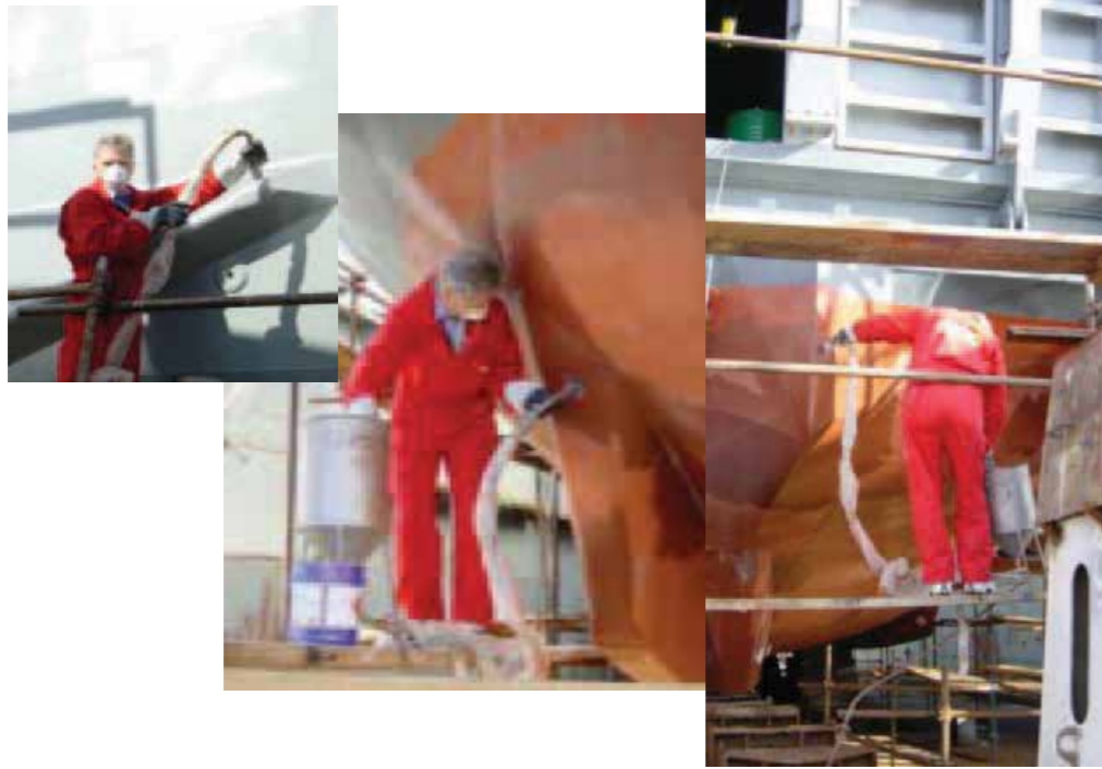
Şekil 6. VpCI® inhibitörünün omurgaya, sürtünme şeridine ve teknenin baş tarafına uygulanması
