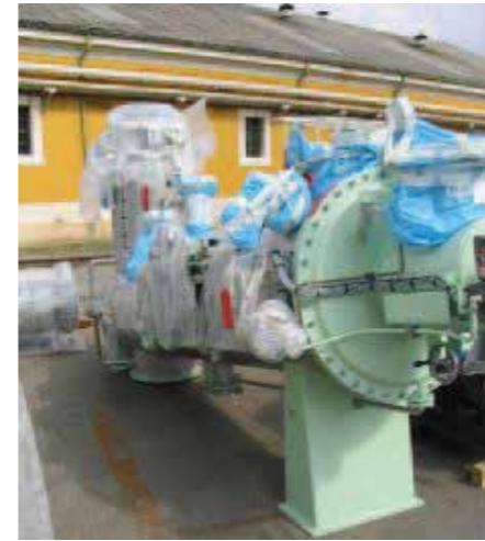
Şekil 8.a Deniz ekipmanlarının VpCI® içermeyen plastik torbalarla korunması
