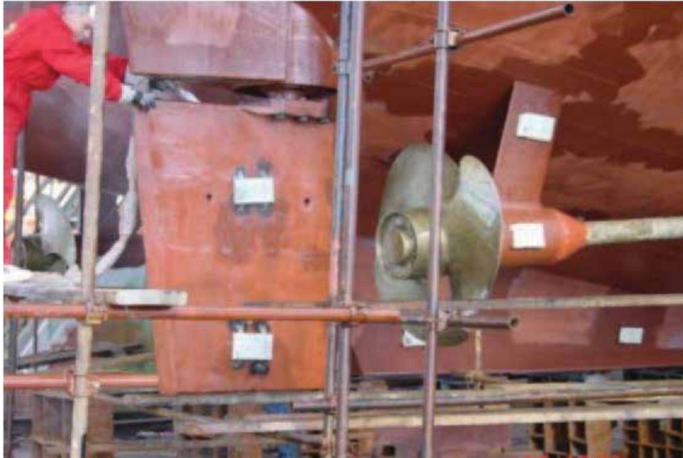
Şekil 3. Dümen kanadının VpCI® ile korunması
