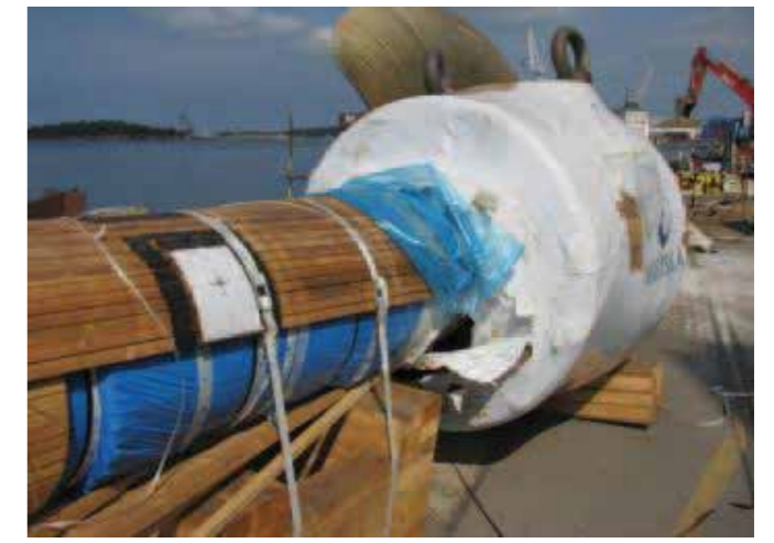
Şekil 8.b Ekipmanın VpCI® 126 film ile korunması
