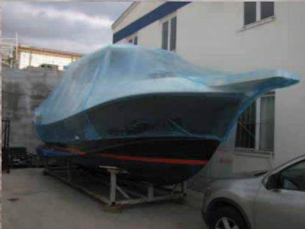
Şekil 17. Hırvatistan'ın kıyı bölgesinde bulunan kuru rıhtımdaki yatın korozyona karşı korunması
