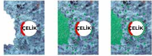
Bozulan yapıdaki dökülmüş betonu kaldırın.
