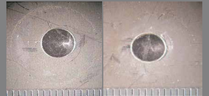
CPC kaplı paslanmaz çeliğin atmosferik maruziyeti için çatlak korozyonu örnekleri (sol - kontrol ve sağ - Cortec'in EcoLine 3690'ı)
