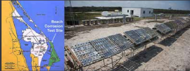
Kennedy Uzay Merkezi, Florida'da Atlantik Okyanusu kıyısındaki korozyon test sahasının konumu (solda) ve ilk CPC uygulamasından ve test sahasında deniz atmosferine maruz kaldıktan sonra paneller (sağda).
